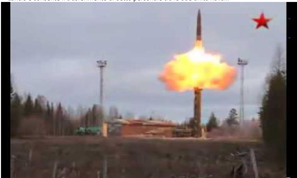
Fig 3: lancio realizzato mediante estrattore pneumatico sviluppato dalla Russia per impiego in lancio da rampa mobile su terra (sistema TOPOL M); fonte you tube
