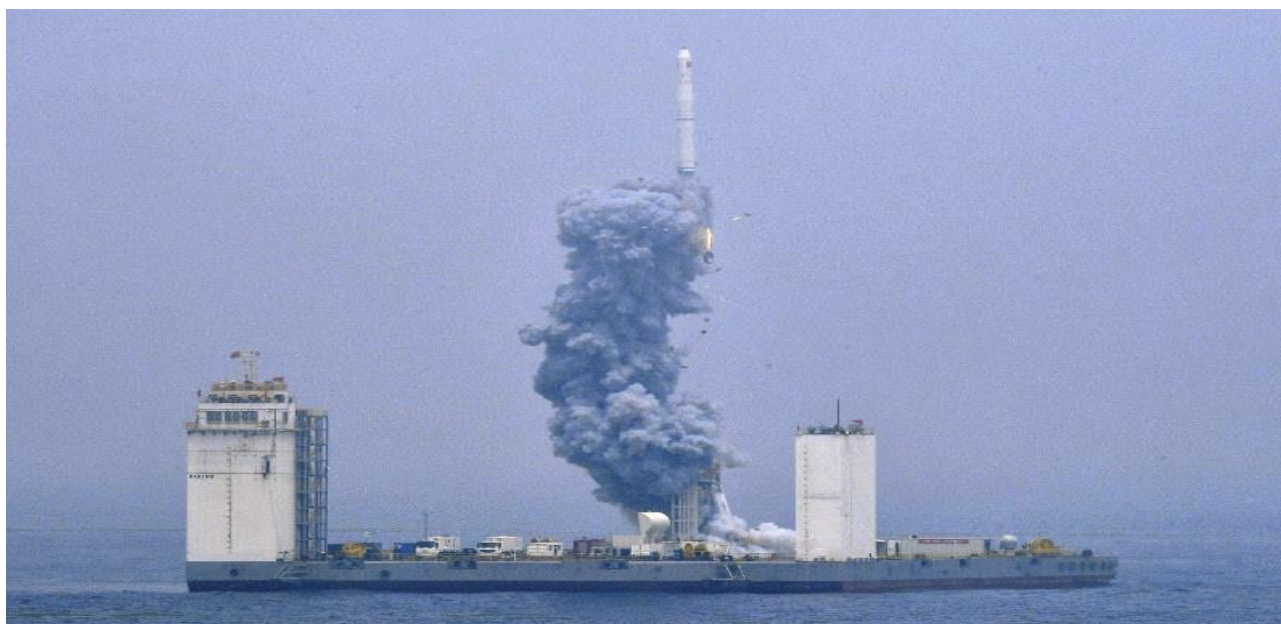
Fig.1 Lancio da Piattaforma navale eseguito dalla Cina (Decollo del lanciatore Lunga Marcia 11 da piattaforma nel Mar Giallo, il 5 giugno del 2019. Da: China Academy of Launch Vehicle Technology (CALT).
